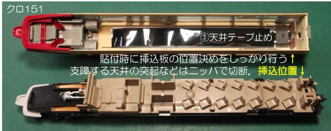
②LEDテープをプラ板で裏打ちして床板の取付部に差込。
